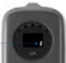
In vertikaler Geräteposition sendet das **ZOOM+** auf der Y-Antenne.
